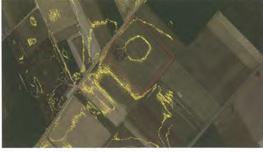
Hoogtelijnen (elke 0,5 meter) op de luchtfoto van de Heinsbergerweg. Er zijn weinig hoogtelijnen zichtbaar wat erop duidt dat het plangebied vrijwel vlak ligt.
