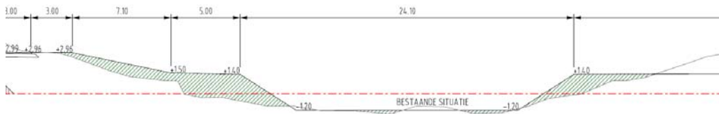
Figuur 7 Dwarsdoorsnede nieuwe watergang ter hoogte van aansluiting met bestaande watergang
