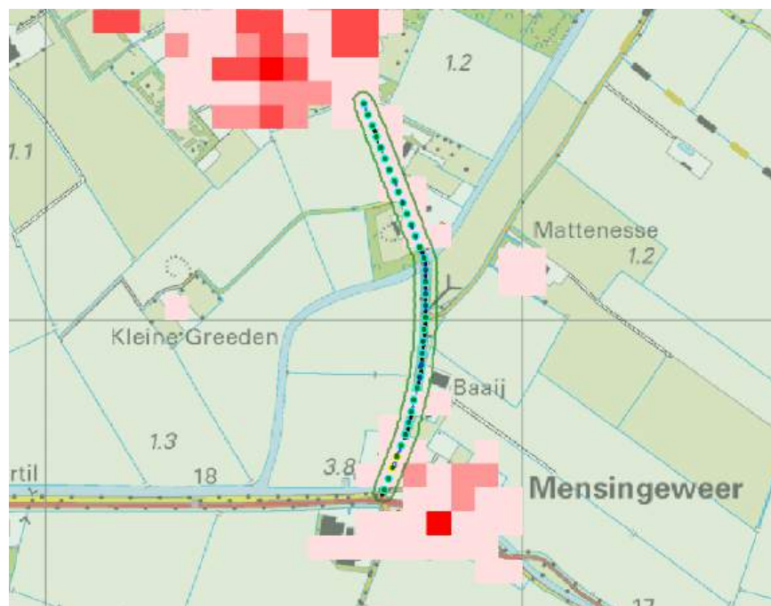
Figuur 22: Overzicht invoer RBMII en inzicht in plaatsgebonden risico 10^{-8} in het groen
