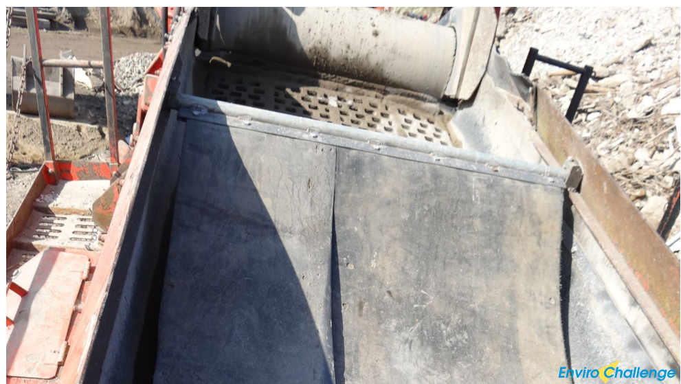
Illustratie 8 : "Stille" zeef, bekleed met kunststofmatten
