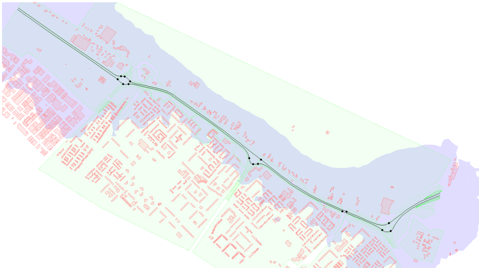
Figuur 5.1: Gebied waar- binnen de voorkeurs- grenswaarde uit de Wgh wordt overschreden in 2020 (paarse contour).
