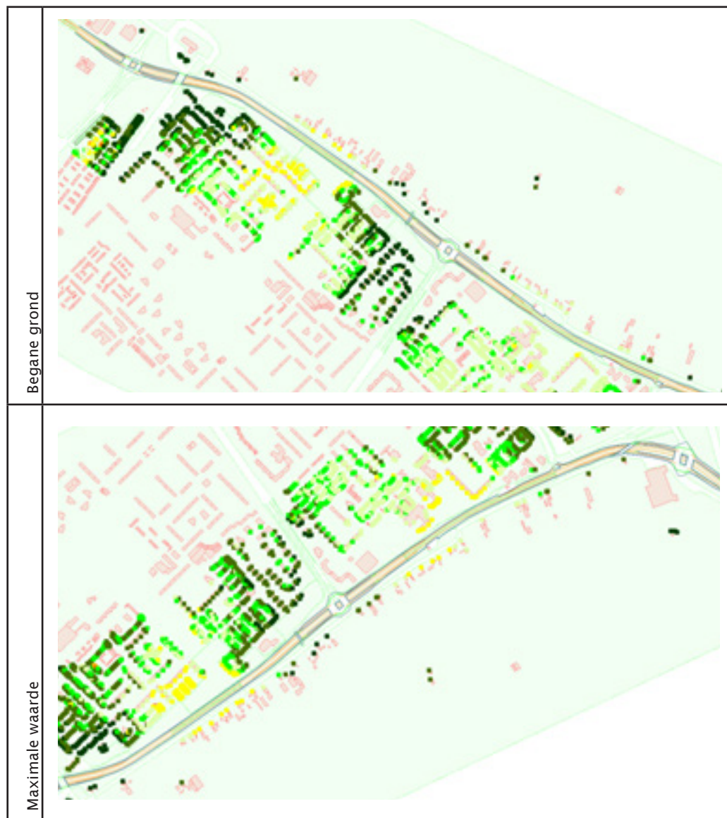
Figuur 6.5 Verandering geluidbelasting plansi- tuatie 2035 (variant 2e, drie onderdoorgangen) ten opzichte van refe- rentiesituatie 2035
