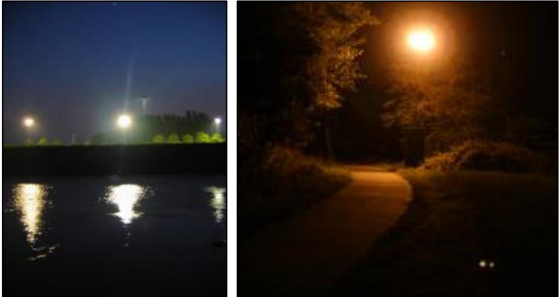
Afbeelding 24: Situaties waar sprake is van verkeerde gebruikte verlichting; teveel verlichting op een donkere vaart (links) en lichtbron die teveel lichtuitstraling naar de omgeving toe veroorzaakt (bron: Haarsma, 2010).
