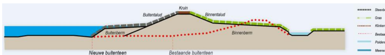
Figuur 3.4 Dwarsprofiel Zuidkade, uitvoeringsmethode compact
