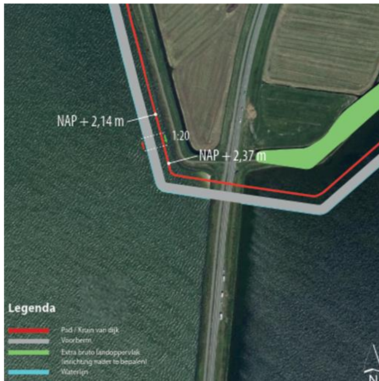
Figuur 3.13 Inpassing Versterking bij de aansluiting Verbindingsdijk (Zuidkade maximaal ruimtebeslag)
