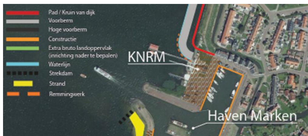
Figuur 3.10 Inpassing Westkade aan de noordzijde van de haven
