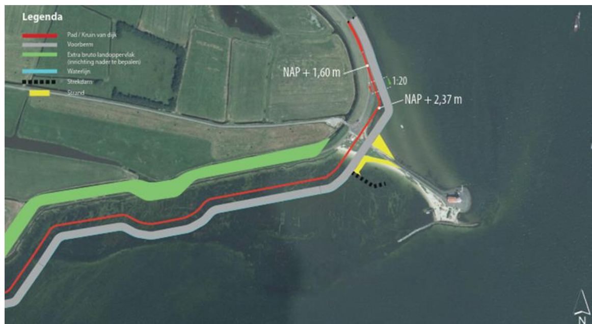
Figuur 3.9 Inpassing Zuidkade en strand bij vuurtoren bij maximaal ruimtebeslag Zuidkade (variant Zandcunet)
