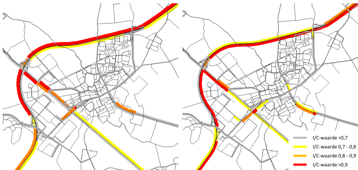
Figuur 2-2 I/C-waarden 2030 ochtend- (links) en avondspits (rechts), zonder opwaardering van de N279 Veghel-Asten, bron: Studie Veghel, N279 Veghel-Asten
