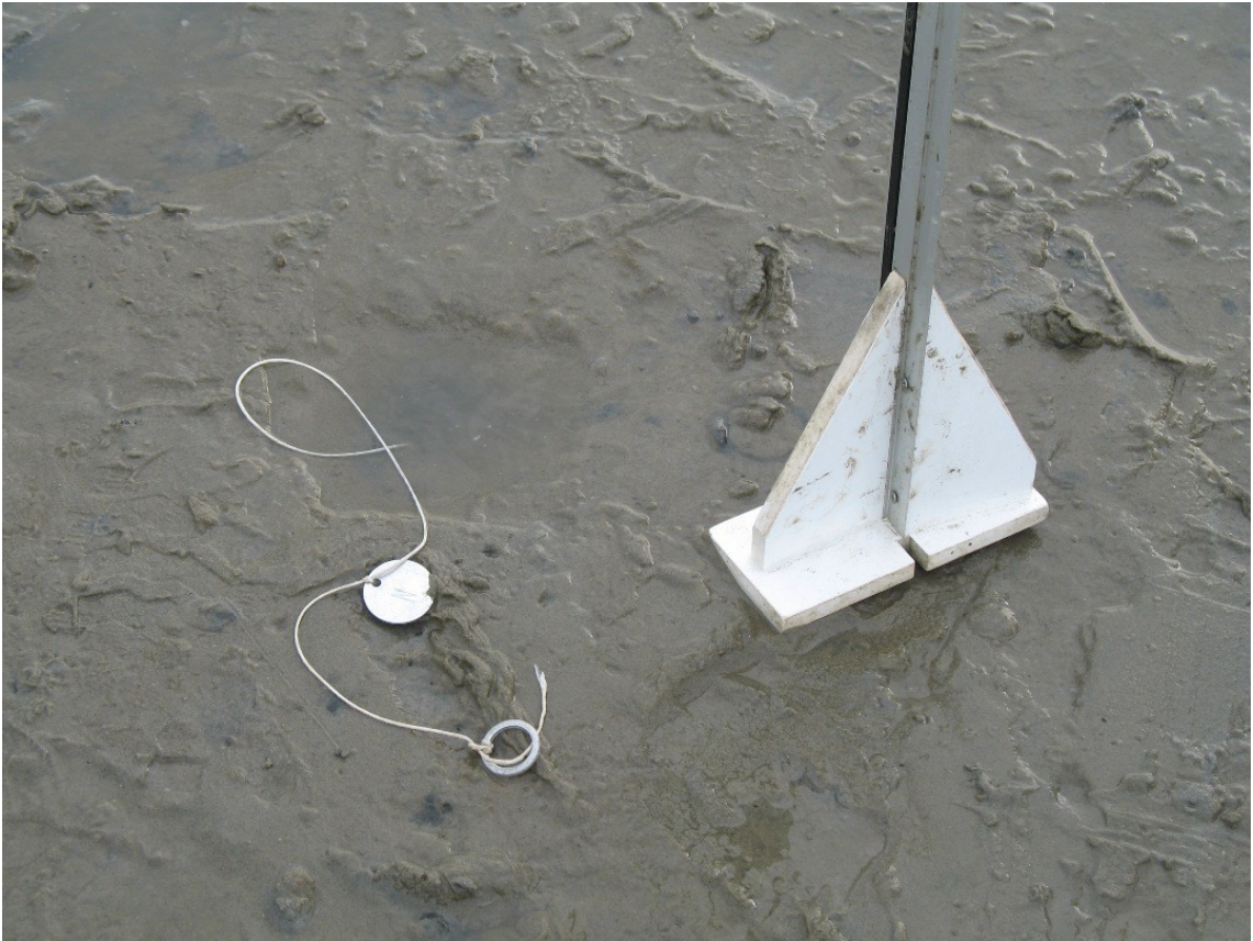
Figuur 2.3 Meetliniaal met meetvoet. Deze wordt steeds op dezelfde wijze op de bodem gezet waarna de lengte van het meettouw langs de schaal wordt afgelezen.
