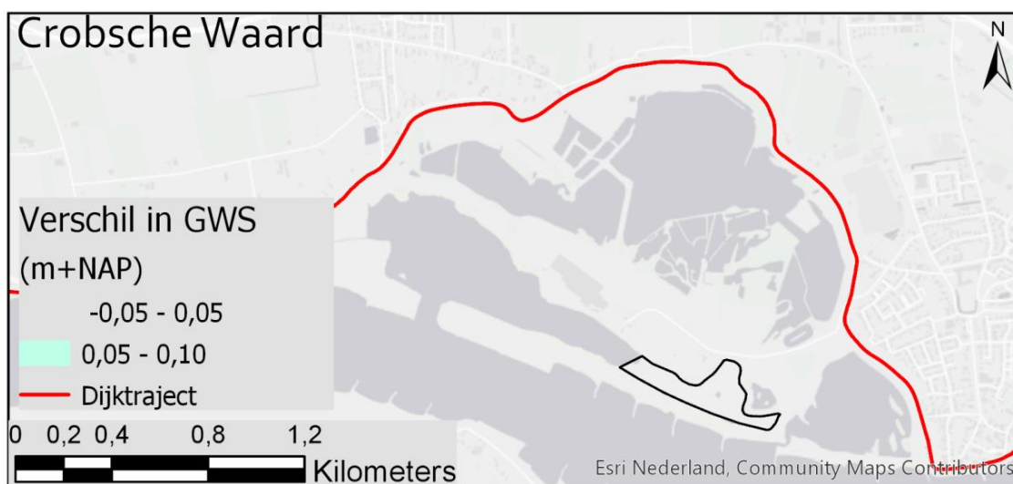
Figuur 4.4: Het effect op de grondwaterstand tijdens hoogwater veroorzaakt door de uiterwaarden vergravingen.
