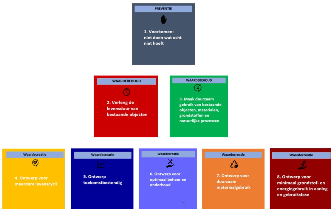
Figuur 1: De 8 circulaire ontwerpprincipes van het MIRT op de drie niveaus preventie, waardebehoud en waardecreatie. De indeling van prestaties uit de Circulaire Peiler is hierop gebaseerd.
