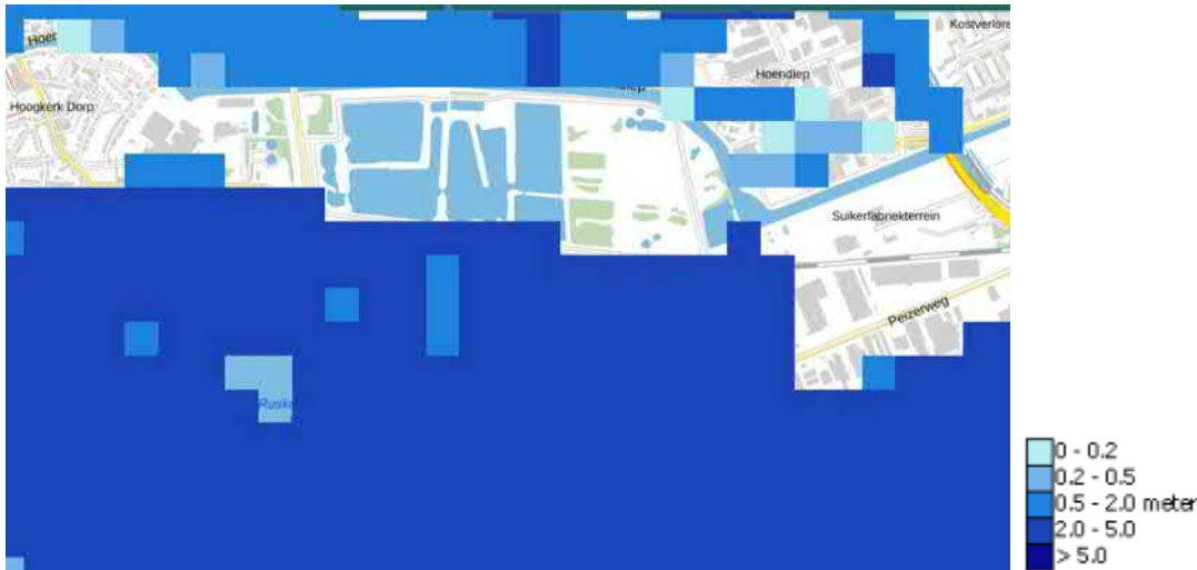
Waterdiepte bij doorbreken regionale keringen (langs kanalen)
