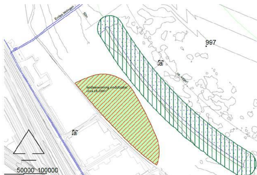
Figuur 2 Voorgestelde situatie met demping achter de 50 m verkorte langsdam
