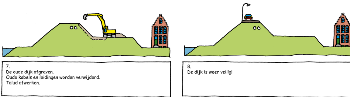
Figuur 4.19 Werkwijze buitenwaartse grondoplossing
