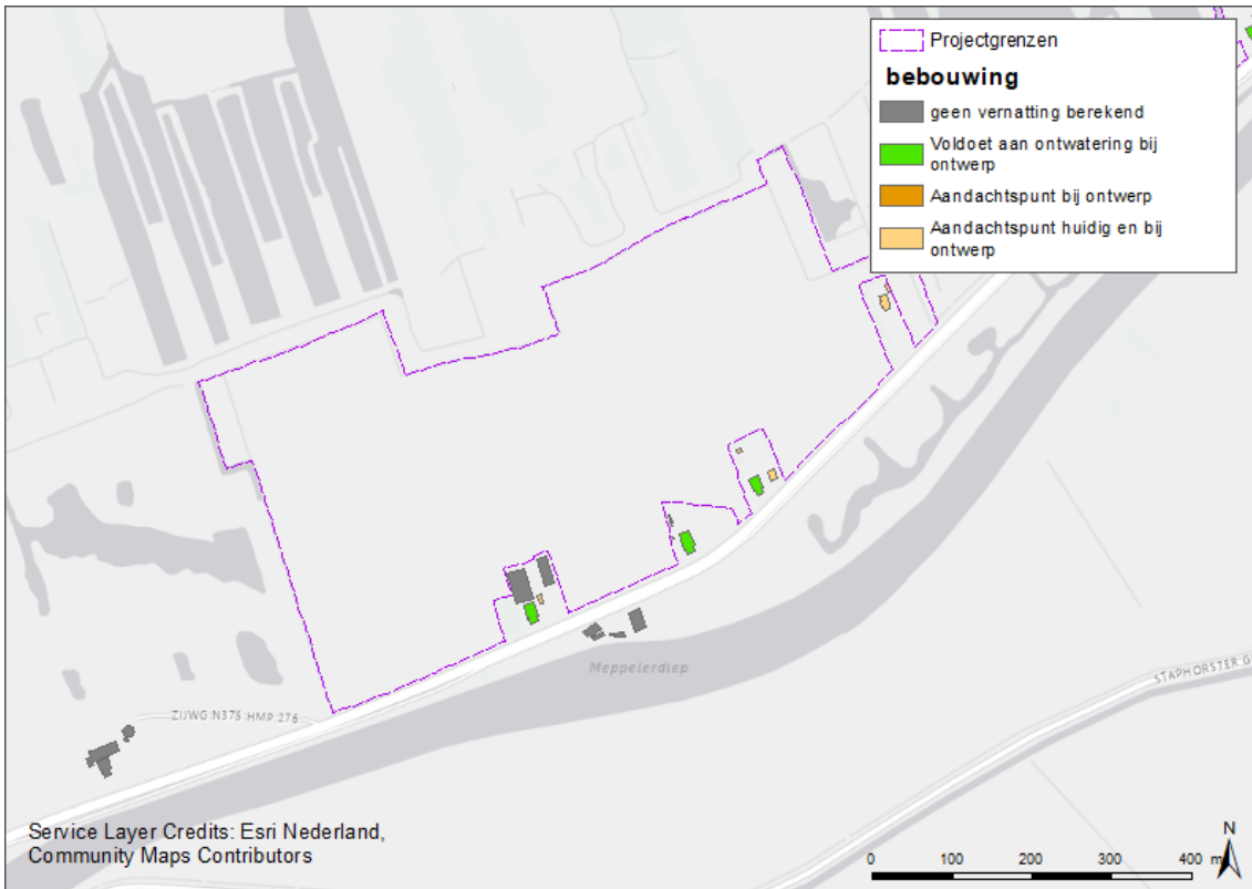
Figuur 40. Effect op bebouwing bij Zomerdijk Beukers bij het scenario zonder kwelsloot, met mitigatie in detailontwatering. Er is hier enkel sprake van verdroging bij bebouwing.
