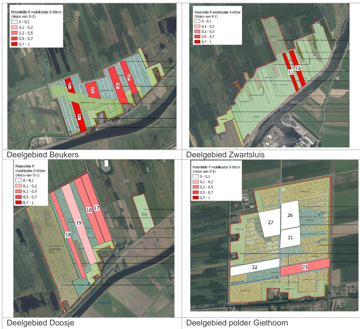
Figuur 4.9 Indicatie van de P mobilisatie uit de bovenste 60cm van de bodem bij vernatting tot maaiveld in deelgebied Beukers (linksboven), Zwartsluis (rechtsboven), Doosje (linksonder) en Giethoorn (rechtsonder).
