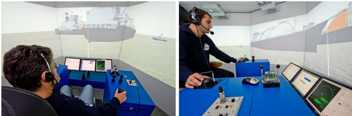
Figuur 2-13: Compact Manoeuvring Simulators in gebruik als sleepboot
