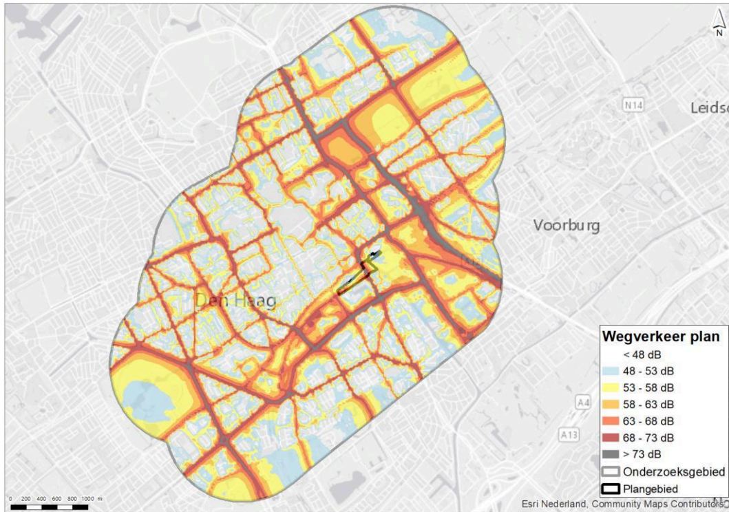
Afbeelding 3.1 Absolute geluidbelastingen in de plansituatie - wegverkeer
