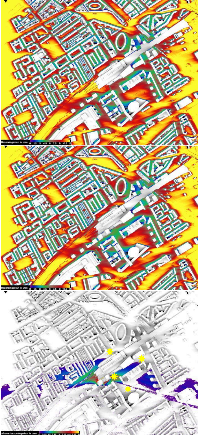
f 3.3 Mogelijke bezonningsduur van de openbare ruimte voor de datum 21 augustus in de huidige bebouwingssituatie (boven), de geplande bebouwingssituatie (midden) en het verschil tussen deze situaties (onder).
