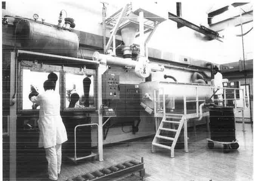
Slib uit de centrifuge wordt met behulp van cement vastgemaakt.
