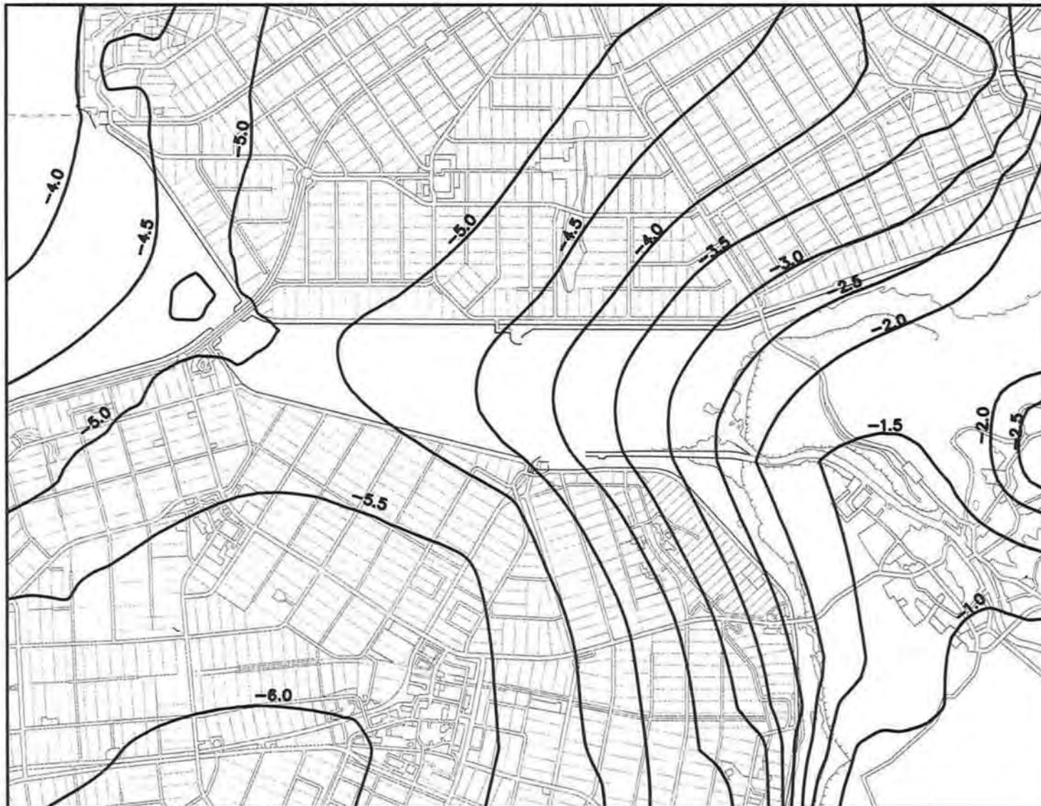
Figuur 12. Stijghoogtenpatroon modellaag 2. Berekend door MODFLOW voor huidige situatie. Stijghoogten in meters t.o.v. NAP.
