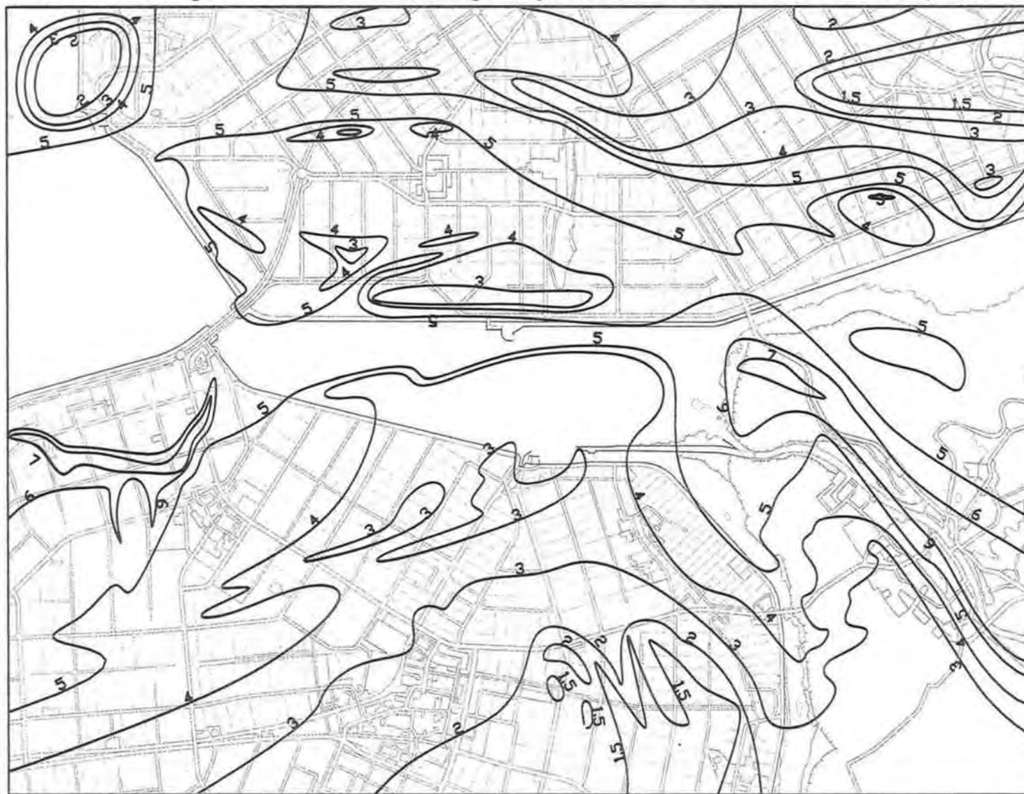
Figuur 3. Dikte van de holocene deklaag in het Ketelmeergebied. Bron: karteringen door de voormalige Rijksdienst voor de IJsselmeerpolders.
