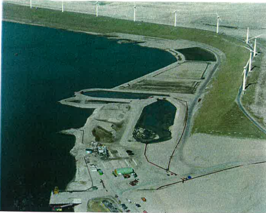
Figuur 5.6. Overzicht van een deel van de Slufter, met binnen de ringdijk de sedimentatiebekkens. Links op de voorgrond is de mechanische zandscheidingsinstallatie te herkennen.
