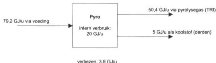
Figuur 4.9.3: Schematische weergave van de energiebalans van de Pyro
