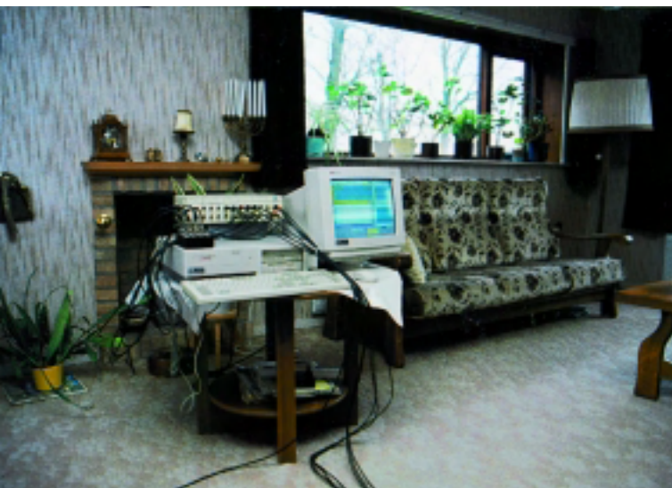
Apparatuur voor het meten van trillingen in een woonkamer
