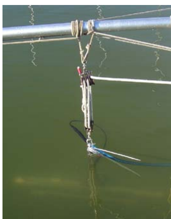
Afbeelding 2. De C-Max CM2 side scan sonar vis onder water (links) en sonar- en navigatiedisplay aan boord (rechts).
