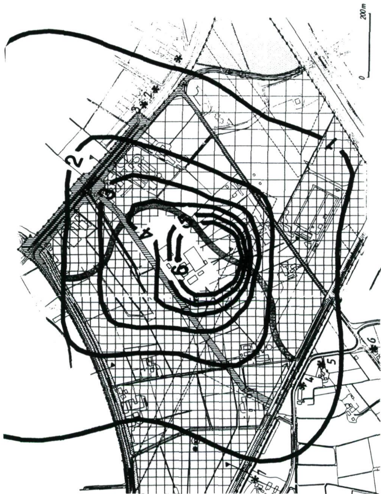
Figuur 5.2.1 Berekende "worste case" geurbelasting (98-percentiel) vanwege de installatie (reserveventilatie-uitlaat, diffuse bronnen en schoorsteen)
