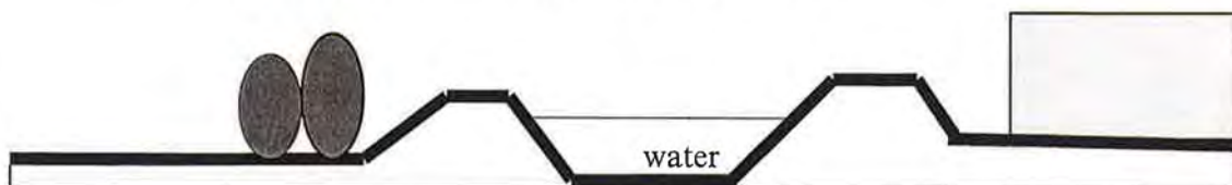
Figuur 4.10 Profiel van een visuele afscheiding, gecombineerd met waterbassins aan de buitenranden van het kassengebied
