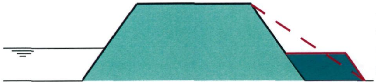
Principe-oplossing I, berm aanleg of taludverflauwing
