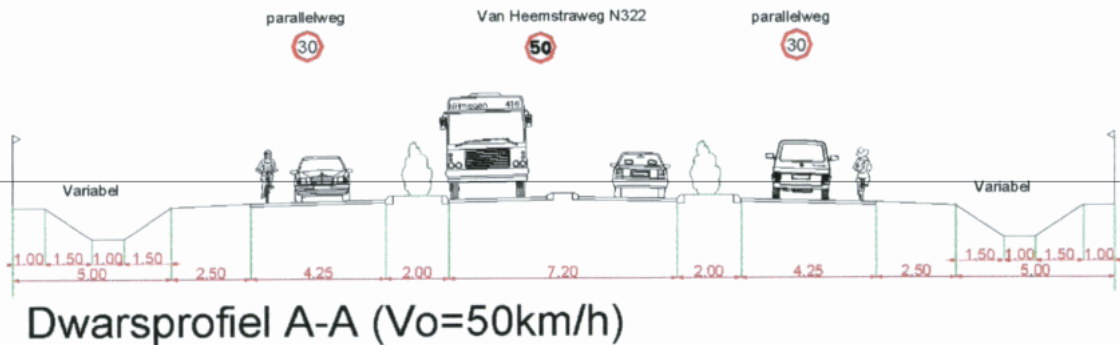
figuur 3.2: visualisatie dwarsprofiel Nulplusalternatief binnen de bebouwde kom
