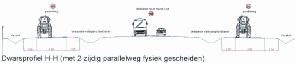
figuur 3.3: visualisatie dwarsprofiel omleidings- en doortrekkingsalternatieven
