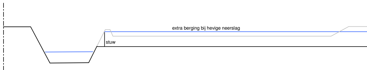
afbeelding 4.7. Schematische doorsnede stuw in blauwe vinger
