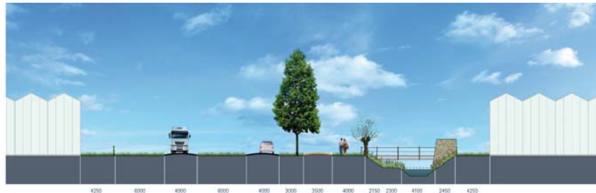
Principeprofiel centrale as met twee enkelbaanswegen
