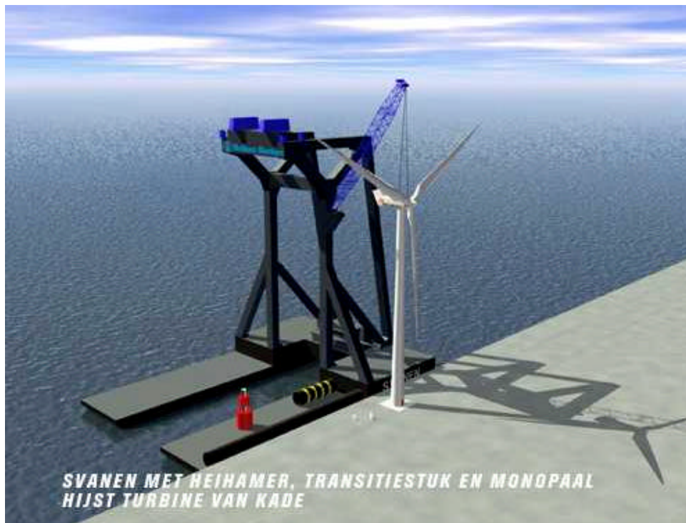
Figuur 4.8 De Svanen met heihamer, transitiestuk en monopaal hijst turbine van kade.
