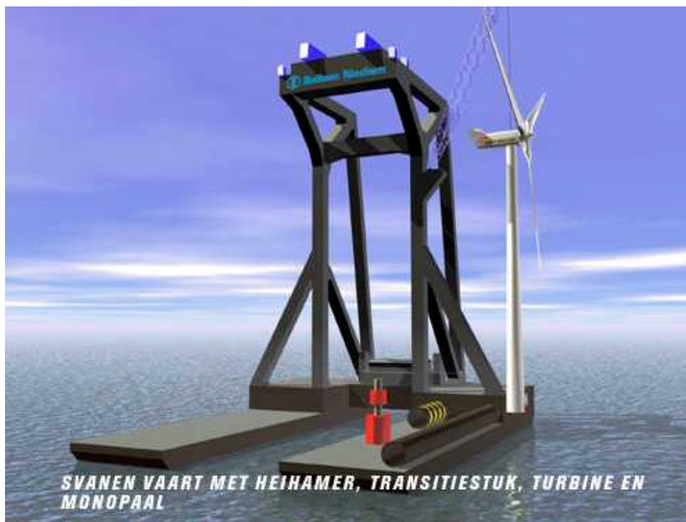
Figuur 4.9 De Svanen vaart met heihamer, transitiestuk, turbine en monopaal naar aan-gebrachte fundatie.
