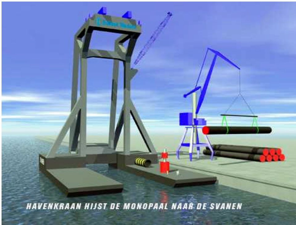
Figuur 4.5 Havenkraan hijst de monopaal naar het installatievaartuig 'de Svanen'.
