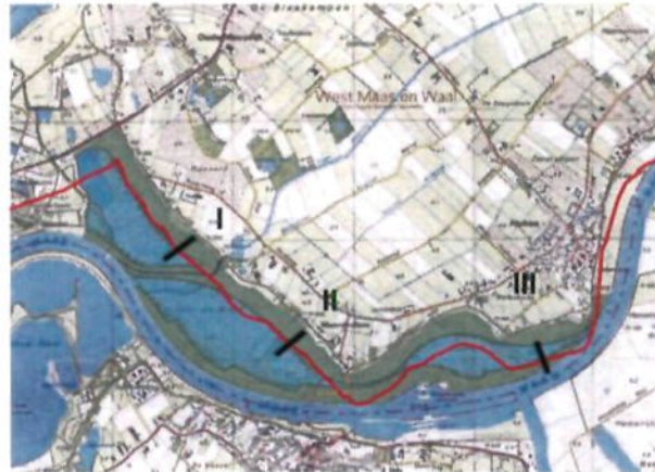
Afbeelding 4.3. Locaties dwarsdoorsneden stabiliteitsberekening (ingetekend in schetsplan)
