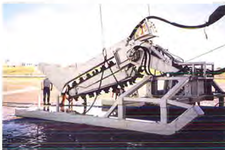
Figuur 3.5: Kabelgraver (Smarttrencher – Dutch Sea Cable)
