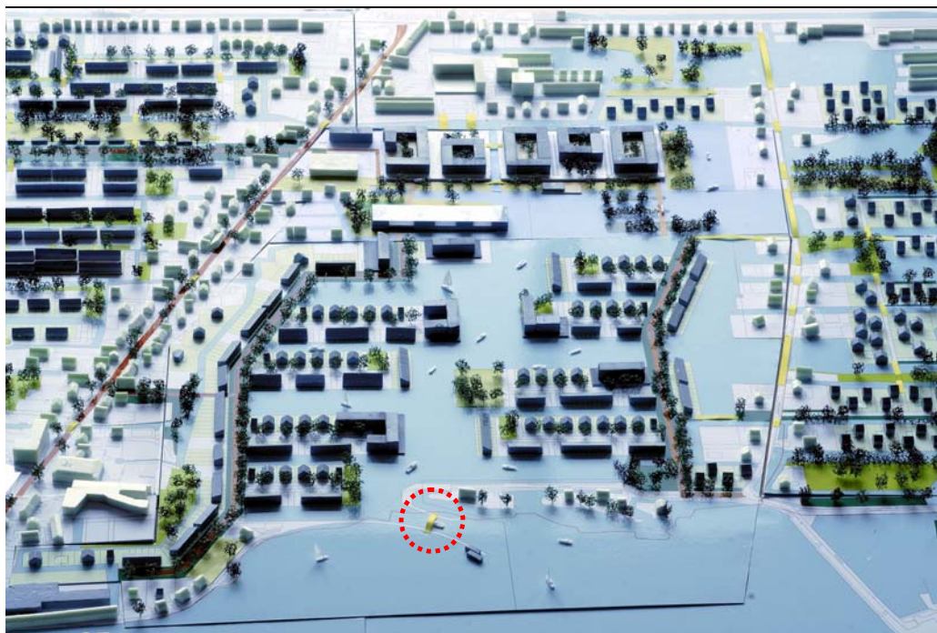
Figuur 4.4 Uitwerking varianten 2A en 2B. Voor variant 2B wordt de bestaande dijk gehandhaafd. De te openen brug (variant 2A, geel in deze figuur) wordt vervangen door een brug en sloepensluis (variant 2B)
