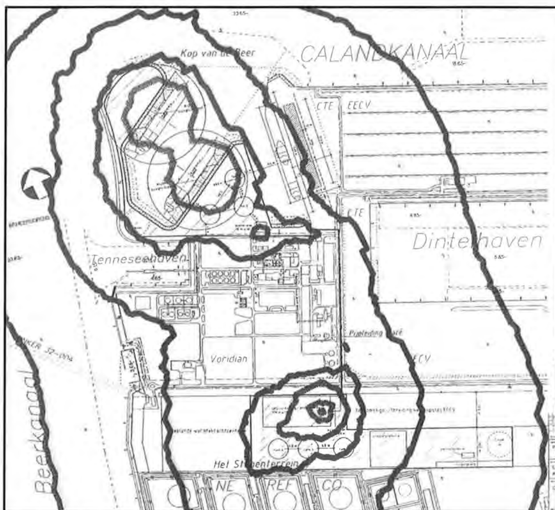
Figuur 6.1 Plaatsgebonden risico LNG import terminal (van buiten naar binnen zijn de plaatsgebonden risicocontouren van 10^{-8} , 10^{-7} , 10^{-6} , 10^{-5} en 10^{-4} weergegeven)
