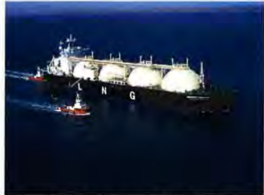
Figuur 2.5 Voorbeeld sferisch LNG schip
