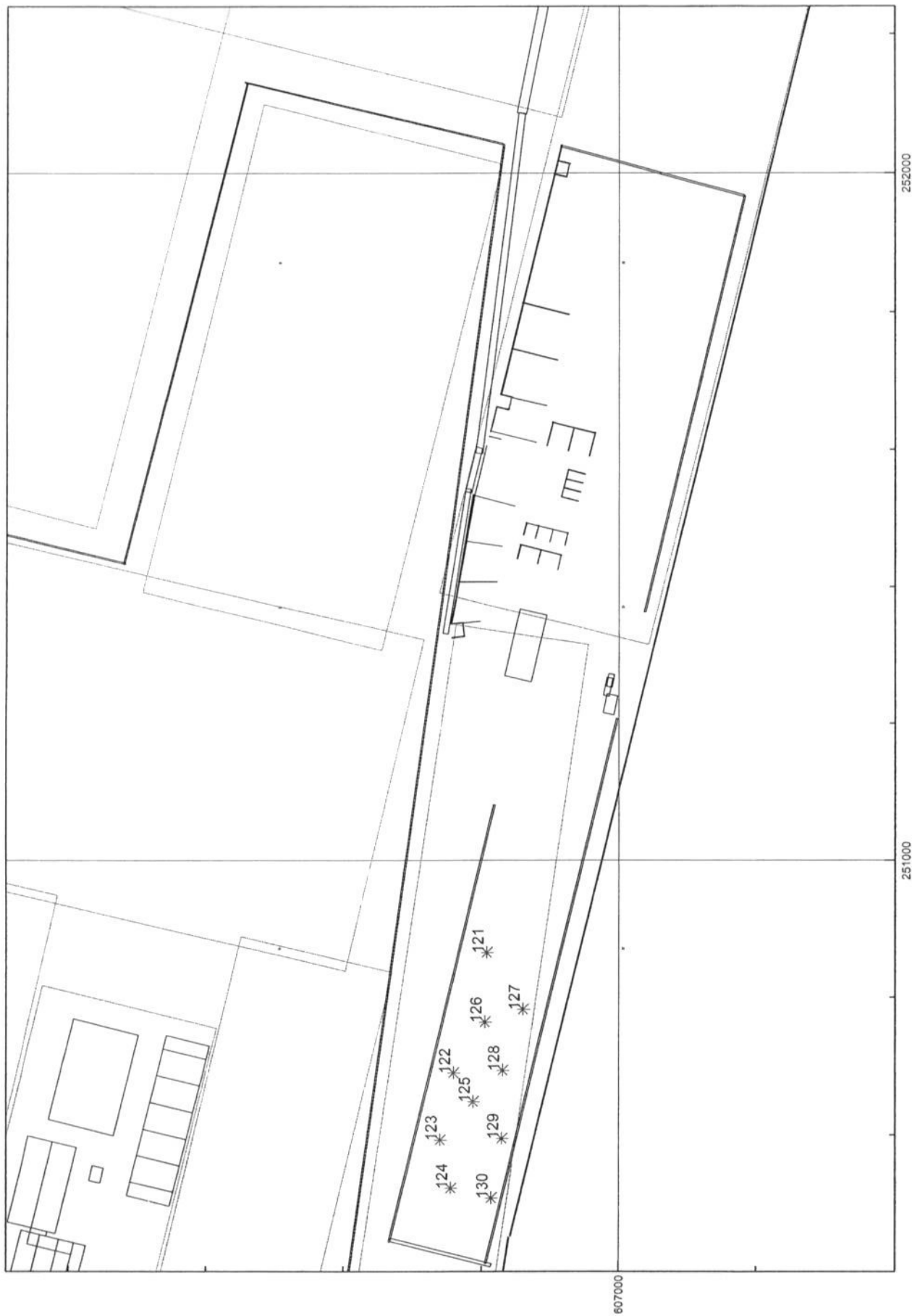
Industrielaan - IL, Theo Pout februari 2005 - diverse beheersvarianten - LA r LT zonder opslag - 2- [F:\ADVIES-1\PROJEC-1\2004\1200\20041292.eph\EMD-EH-2], Geonose V4.03 figuur 3.7: Overzicht rekenmodel met de situering van de geluidbronnen omzetter
