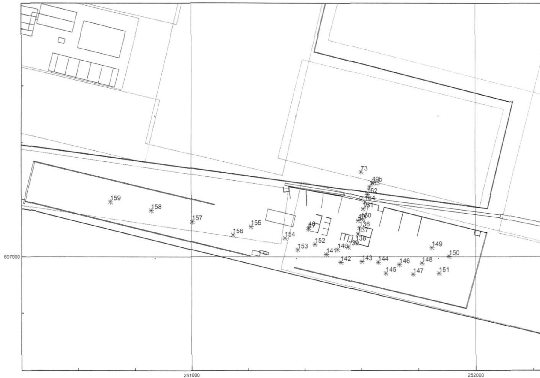
figuur 3.8: Overzicht rekenmodel met de situering van de geluidbronnen betoncentrale, dumpers en losinstallatie schepen
