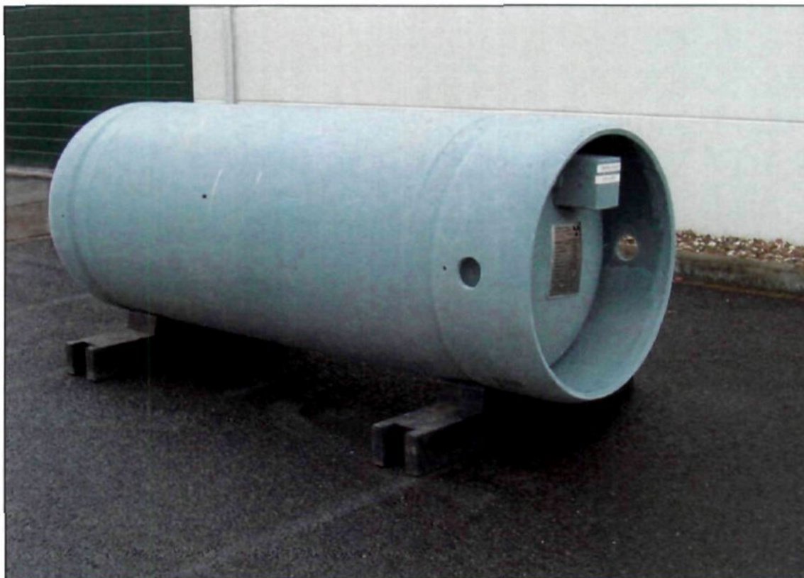
gestandaardiseerde container voor opslag UF 6
