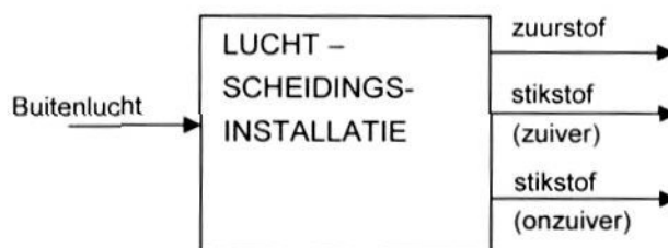
Figuur 4.1.10 Principeschema Luchtscheidingsfabriek
