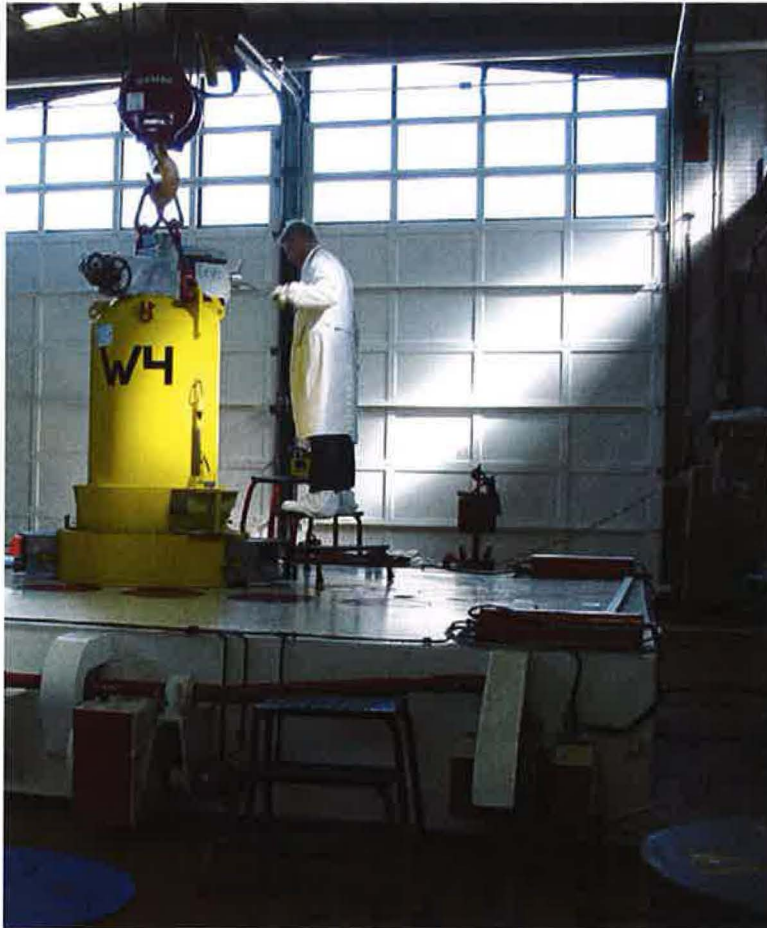
figuur 6 Laden van een W-container op vulwagen in WSF.
