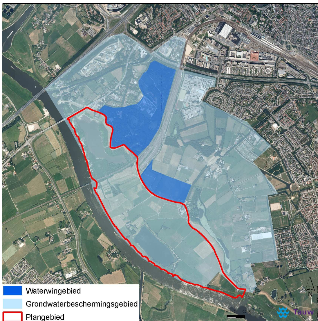
Figuur 3.1 Waterwinning en Grondwaterbeschermingsgebied na verplaatsing van de putten
