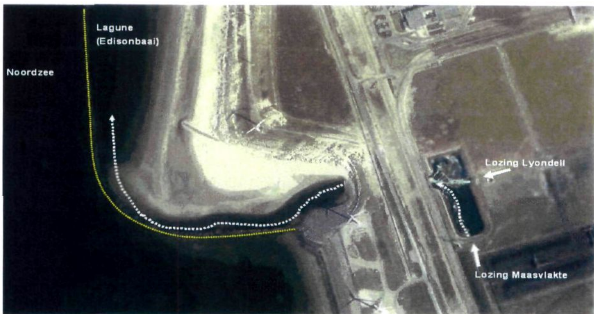
Figuur 3 Lozing van centrale Maasvlakte en Lyondell op de uitlaatvijver en lagune. De witte stippellijn geeft de route van het koelwater weer, de gele stippellijn arceert de blokkendam die de lagune afsluit van de Noordzee (bron: Google-earth)
