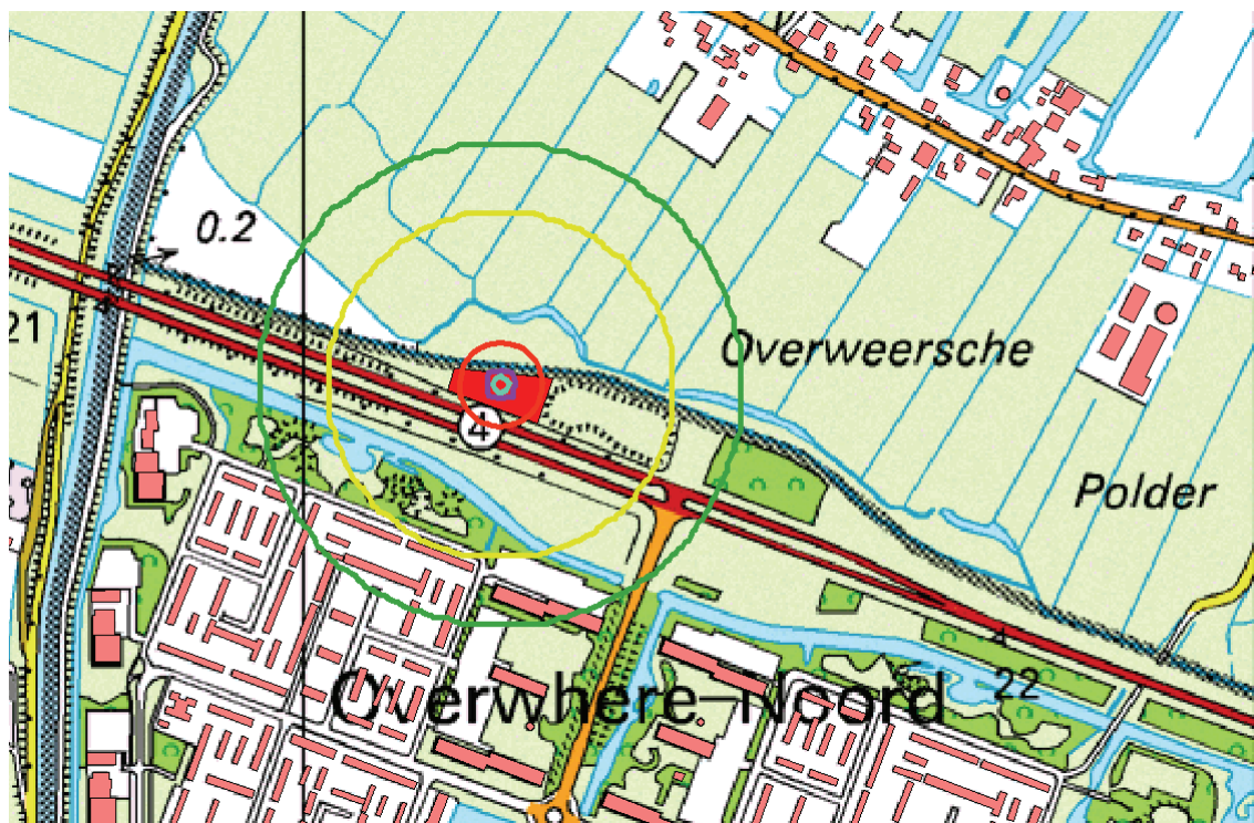
Figuur 9.2: De plaatsgebonden risicocontouren van het Nulplusalternatief, Verbredingsalternatief en het Stroomwegalternatief met van binnen naar buiten de 10^{-4} contour (lichtblauw), 10^{-5} contour (paars), 10^{-6} contour (rood), 10^{-7} contour (geel) en de 10^{-8} contour (groen) Binnen de PR contour van 10^{-6} per jaar mogen geen kwetsbare objecten liggen. In de figuur is goed te zien dat binnen de PR contour van 10^{-6} geen kwetsbare objecten liggen.
