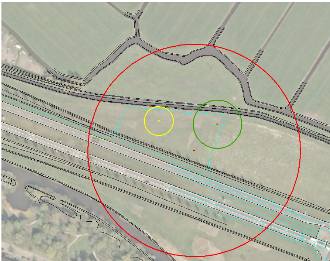
Figuur 4.2 PR 10^{-6} contouren bij doorzet op jaarbasis \geq 1000 \text{ m}^3 conform de Revi 5
