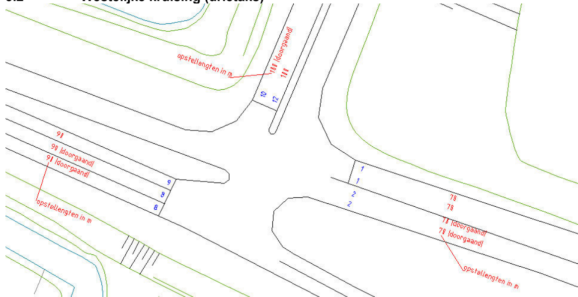
Figuur 6: Signaalgroepnummering van de Oostelijke kruising zijn in bovenstaande figuur met blauwe cijfers weergegeven.
