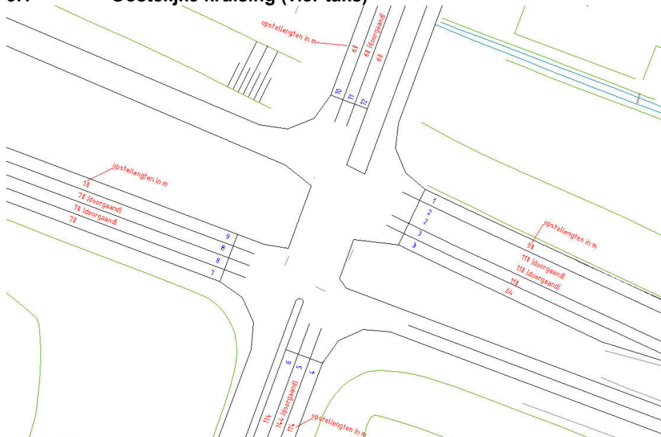
Figuur 5: Signaalgroepnummering van de Oostelijke kruising zijn in bovenstaande figuur met blauwe cijfers weergegeven.
