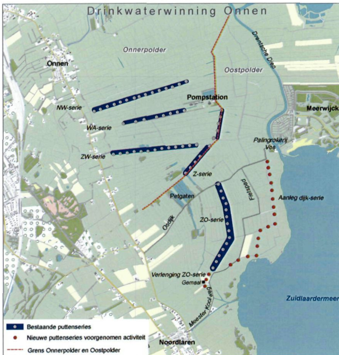
Afbeelding 3. Drinkwaterwinning Onnen met pompstation, puttenseries en voorgenomen activiteit *
