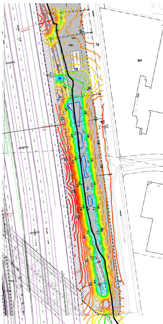
Figuur 4.1b: Geconstrueerde maaiveldhoogte op basis van inmetingen
