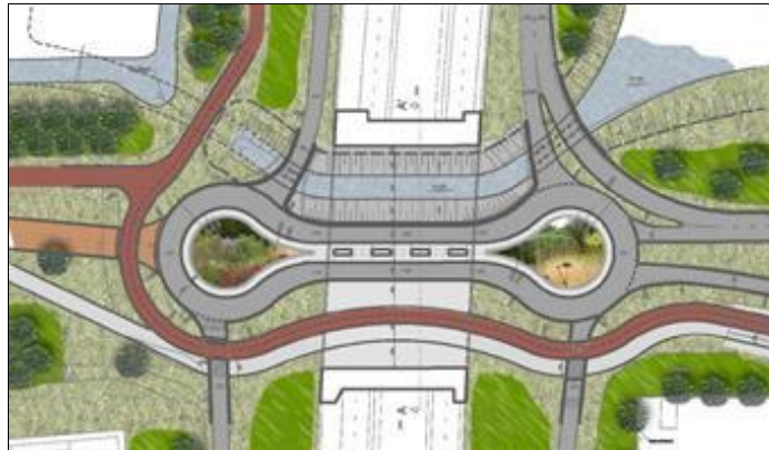
..... Figuur 5.3 Principeschets van een botonde
