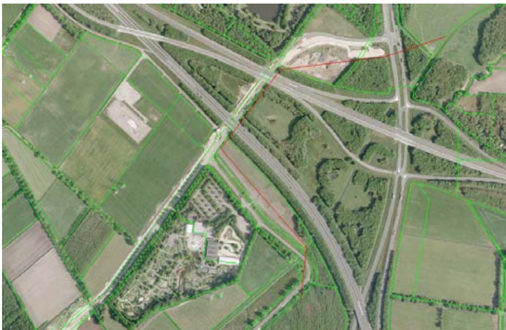
Figuur 4.8. Omlegging van de beekloop Anreeperdiep/Witterdiep zoals voorgesteld door de gemeente Assen (Bron: gemeente Assen). Hierbij worden naast de bestaande viaducten in de N33 en A28 eco-viaducten aangelegd. Dit maakt geen onderdeel uit van het MER/OTB verdubbeling N33.
