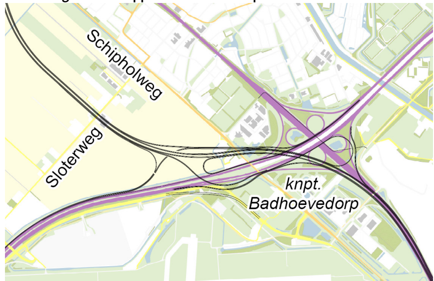
Afbeelding 2.7. Knooppunt Badhoevedorp - klaverturbine
